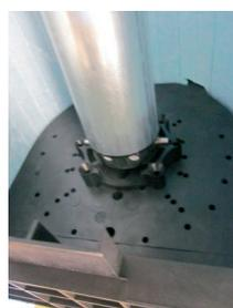
3 - Insérer l'embout télescopique dans le téton du coussinet, remettre la goupille et bloquer la bague d'arrêt
